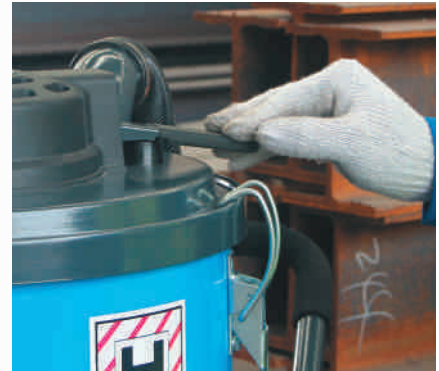
Półautomatyczne oczyszczanie filtrów
