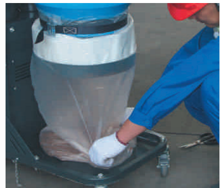
Pojemnik na pył, szybkie i łatwe usuwanie wypełnionego pojemnika
