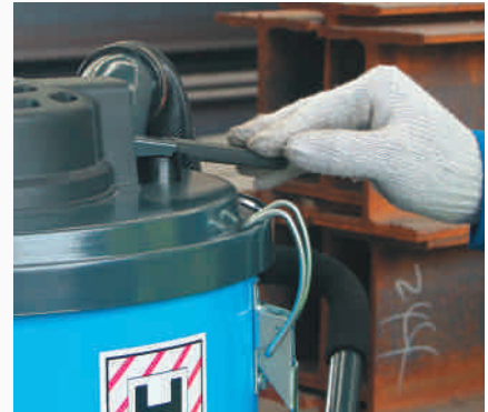
Półautomatyczne oczyszczanie filtrów
