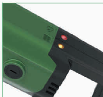
Czerwona lampka: przeciążenie Żółta lampka: przegrzanie Czerwona & żółta: wymiana szczotek
